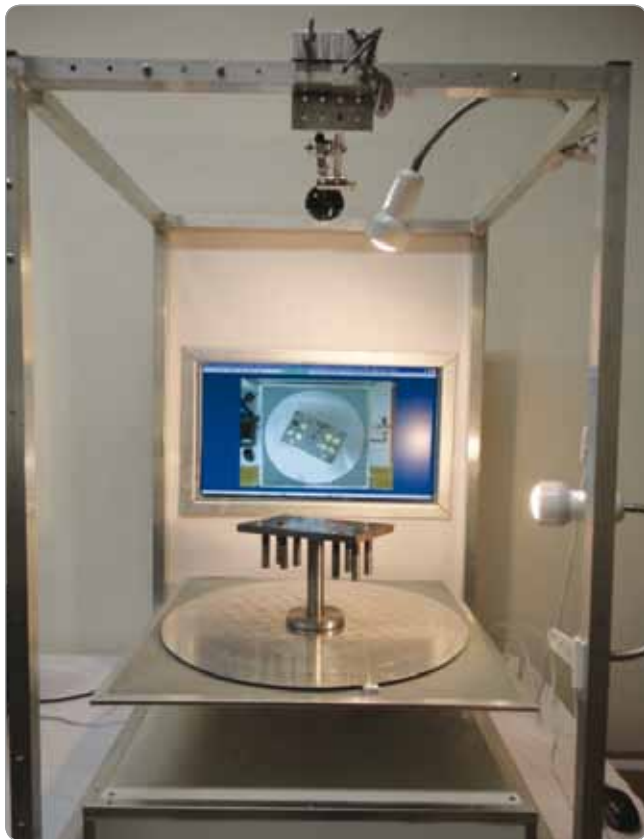
Obr. 2 Polohovateľný pracovný stôl s upnutou súčiastkou
